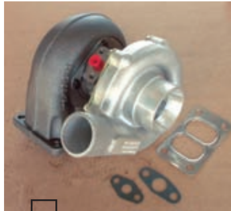
Турбокомпрессоры модели K27TI — альтернатива российским и чешским изделиям для камазовских моторов стандарта Евро-2.
