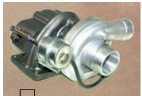
Регулируемый ТК S14TI может заметно улучшить характеристики минских дизелей Д245, применяющихся на многих автомобилях ЗИЛ, МАЗ, ГАЗ и ПАЗ.
